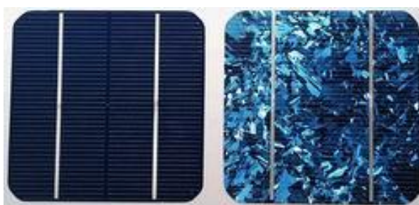
Obrázek 3 Monokrystalický článek (vlevo) a polykrystalický článek [12]
