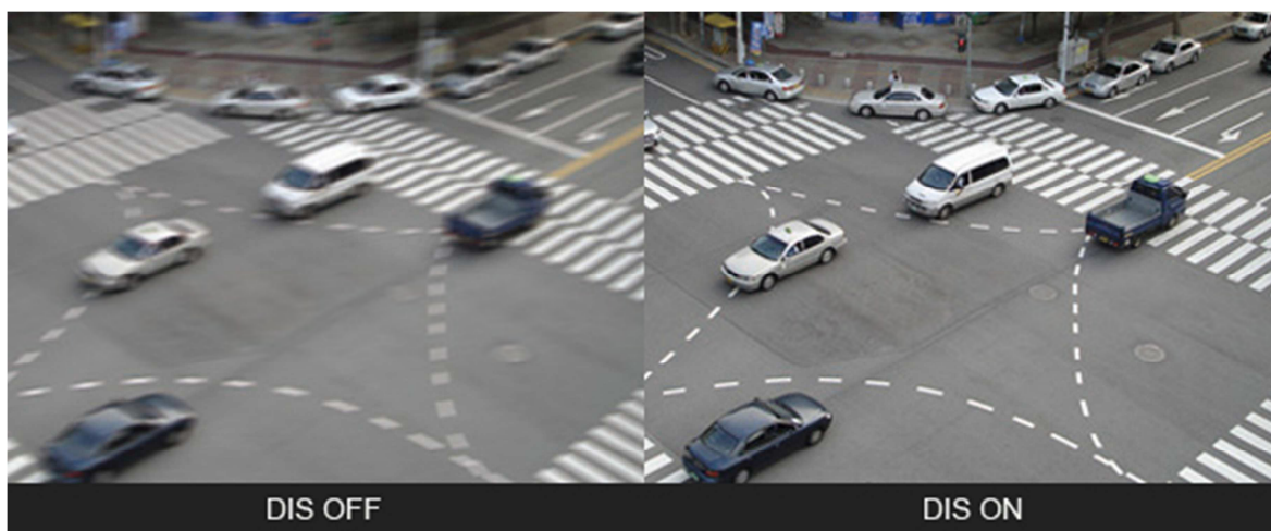
Obrázek 22: Příklad obrazu se zapnutou a vypnutou funkcí DIS. [33].
