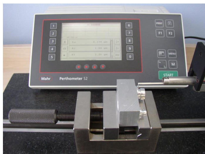
Obr. 55. Měřicí přístroj na měření jakosti povrchu Mahr Perthometer S2
