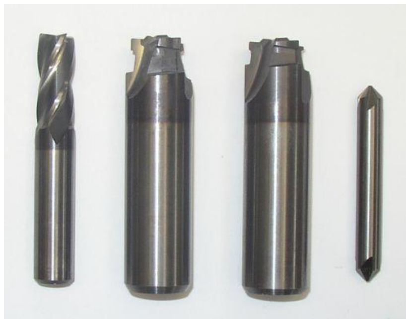
Obr. 52. Monolitické SK frézy, zleva T07, T10, T11 a T04
