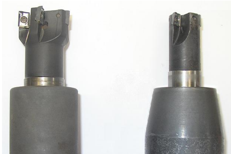
Obr. 53. Frézovací hlavy osazené VBD, zleva T01 a T06
