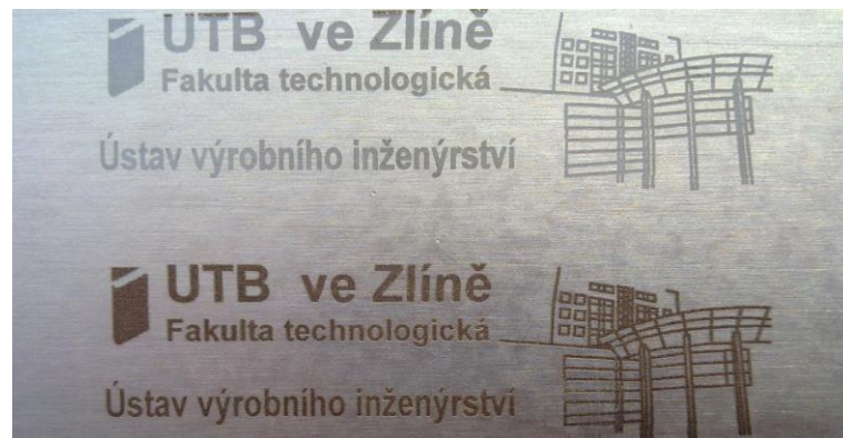
Obr. 45. Další ukázky obrábění vzorku A (vrchní obrázek - výkon/rychlost = 20/100%, spodní obrázek - 40/100%)
