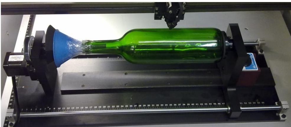
Obr. 76. Upnutí láhve do rotačního zařízení
