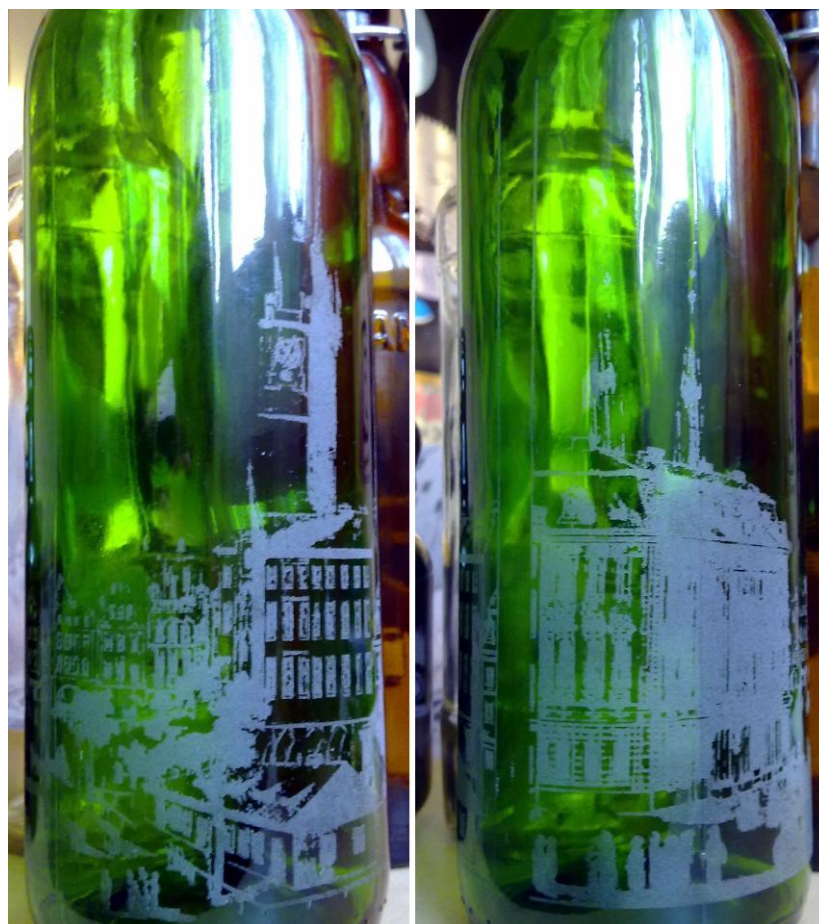
Obr. 80. Laserové gravírování skleněné láhve (výkon laseru 20% a rychlost posuvu 60%)
