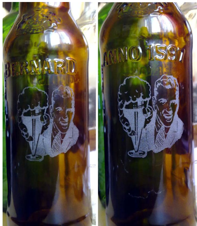
Obr. 82. Laserové gravírování skleněné láhve (vlevo: výkon laseru 20% a rychlost posuvu 60%, vpravo: výkon laseru 30% a rychlost posuvu 60%)
