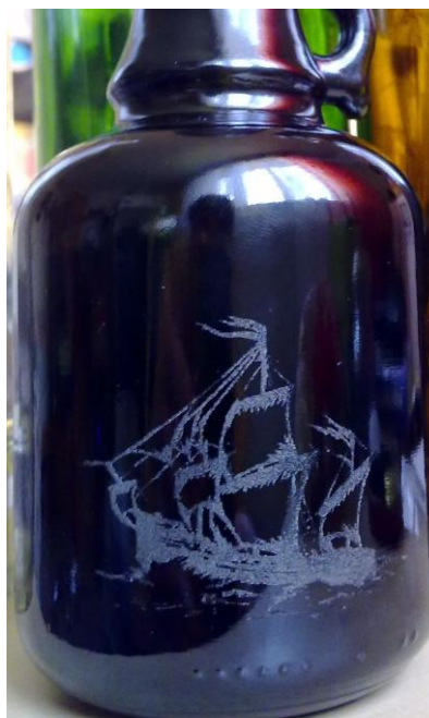
Obr. 84. Laserové gravírování skleněné láhve (výkon laseru 20% a rychlost posuvu 60%)
