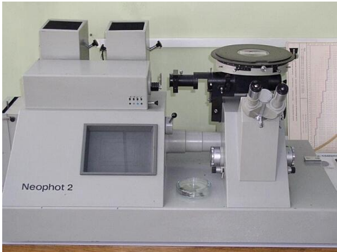
Obr. 12. Metalografický mikroskop Neophot 2 [20]
