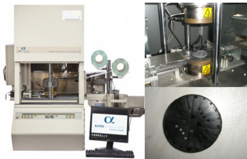
Obrázok 16 – Bezrotorové oscilačné zariadenie RPA 2000, s detailom hlavy a vzorkom po meraní [68].
