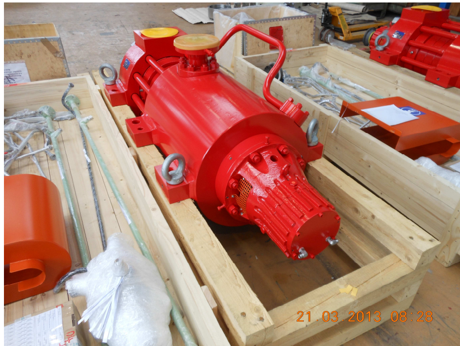
Obrázek 9.1 Upevnění pro přepravu – rám [Zdroj: vlastní]
