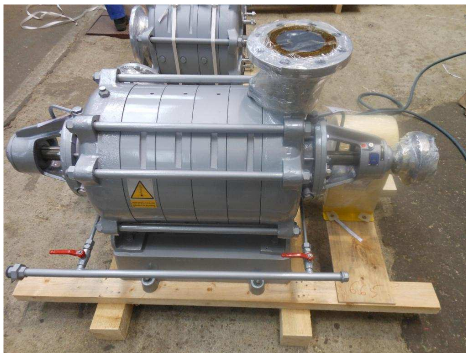
Obrázek 9.2 Upevnění pro přepravu – podložka [Zdroj: vlastní]
