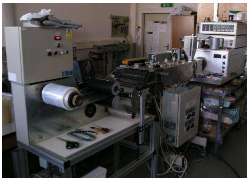
Obrázek 23 Vytlačovací stroj Brabender Plasti-Corder s plochou vytlačovací hlavou
