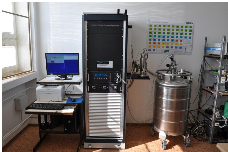
Obr. 25 Buňka pro měření zejména dlouhodobých časových závislostí elektrických a dielektrických vlastností plastických látek.
