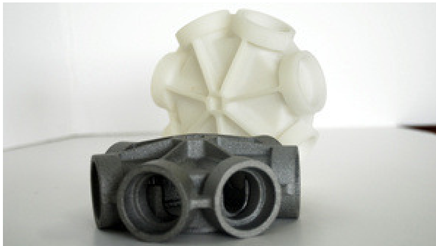
Obr. 30. Dílec vyrobený technologií SLS [27]
