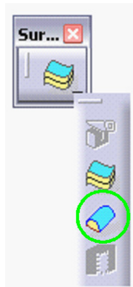
Obr. 74. Nástroj „Close Surface“
