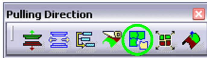
Obr. 109. Nástroj „Aggregate Mold Area“
