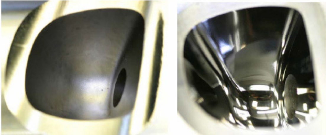
Obr. 23. Leštěná dutina formy [20]
