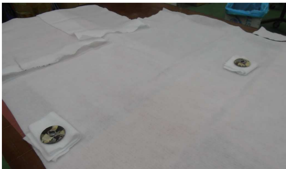
Obr. 40: Odvzdušňovací tkanina se dvěma přívody k vakuové pumpě
