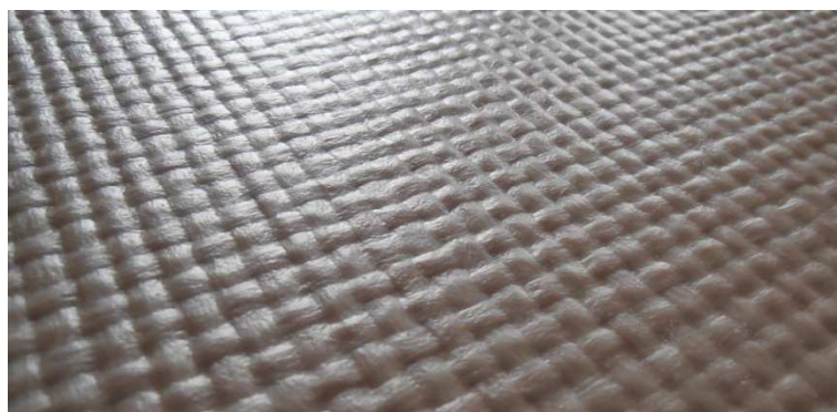
Obr. 50: Detail osnovy prepregu nepohledové vrstvy
