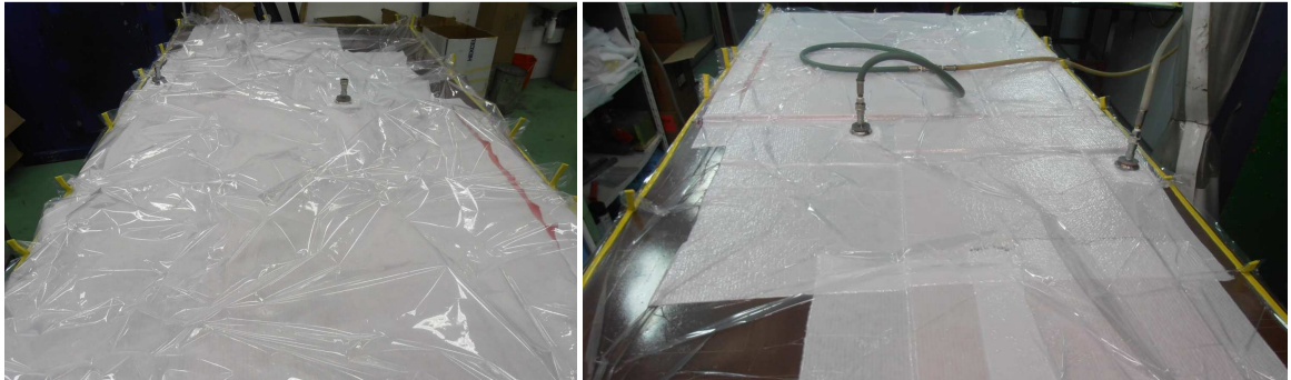
Obr. 41: Výrobní proces před a po vytvoření vakua
