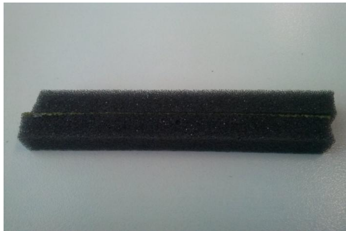
Obr. 18. Vzorek lepený po celé délce
