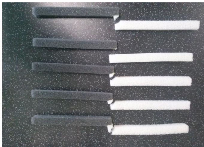
Vzorky PUR 12 – přeplátování 5mm - Pattex
