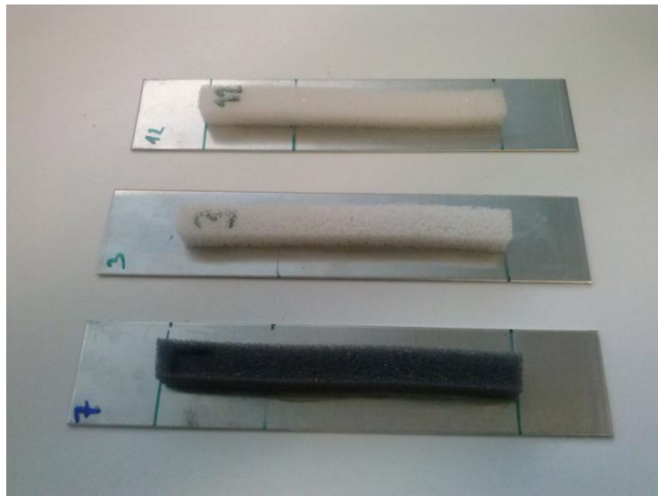
Obr. 20. Vzorky pro peel-test
