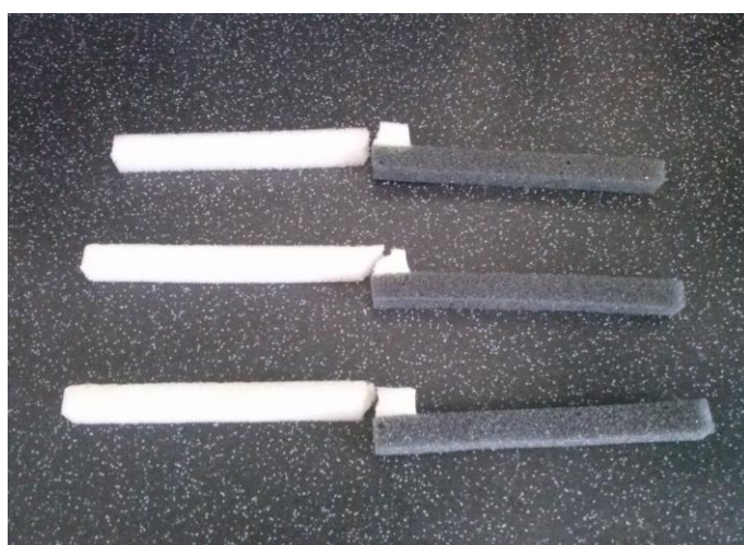
Vzorky PUR 13 – přeplátování 10mm - UHU
