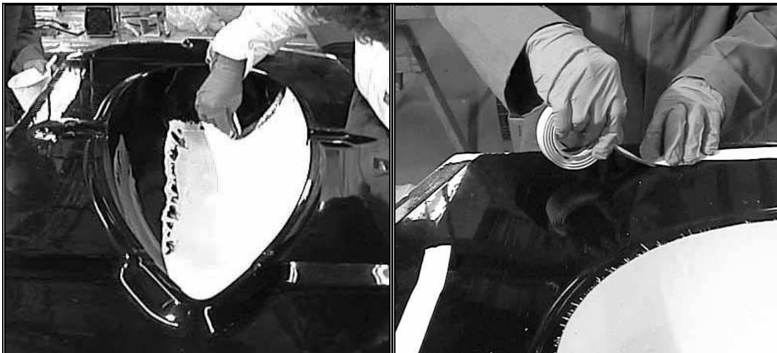
Obr. 13 Nátěr gelcoatu a lepení těsnící pásky na formu [16]
