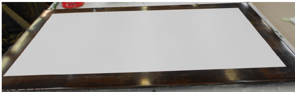
Obr. 21 Gelcoat nanesený na formě
