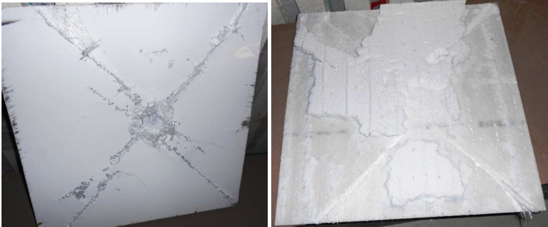
Obr. 46 Vzorek A po průstřelu
