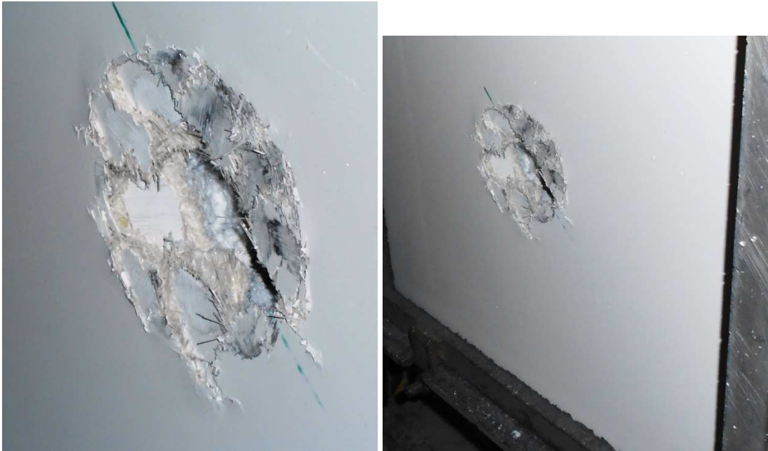
Obr. 47 Vzorek B po průstřelu
