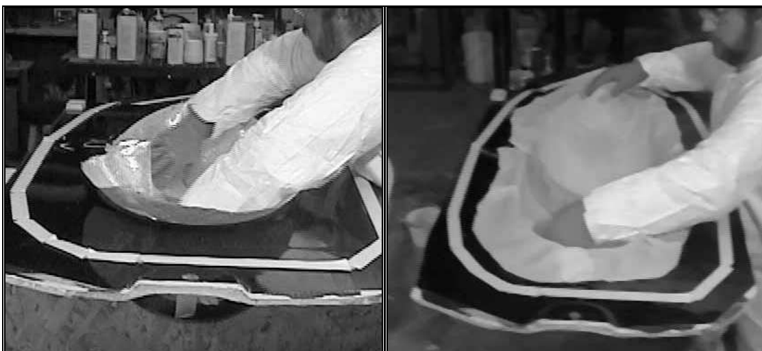
Obr. 14 Kladení suché výstuže do formy a kladení technologických vrstev [16]
