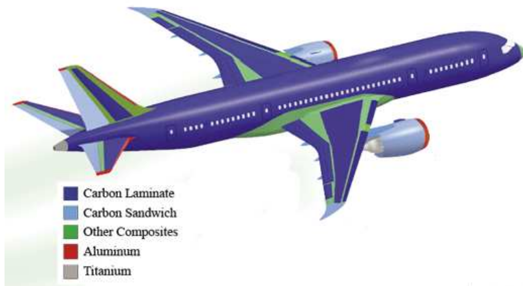
Obr. 3 Materiálové složení letadla Boeing 787 Dreamliner [7]
