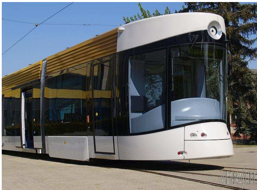
Obr. 5 Použití kompozitních kapot na vlakové soupravě [9]
