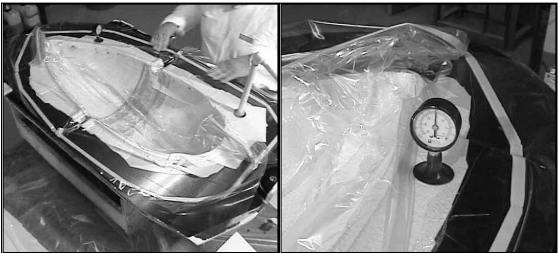
Obr. 16 Vakuovací proces a kontrola a následný transport matrice do formy [16]
