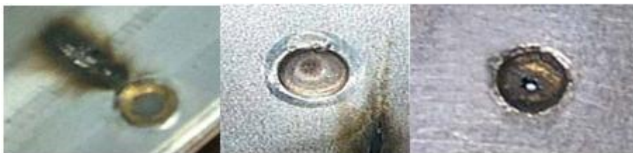
Obr. 8. Ukážka niekoľkých chýb bodového odporového zvarovania.
