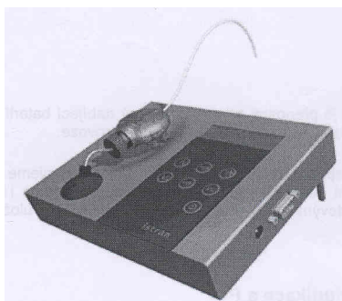
Obrázek 2 Coulometrický analyzátor C-Vit
