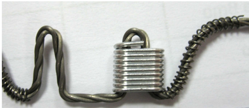
Obr. 6: Hliník nasazený na wolframové spirále
