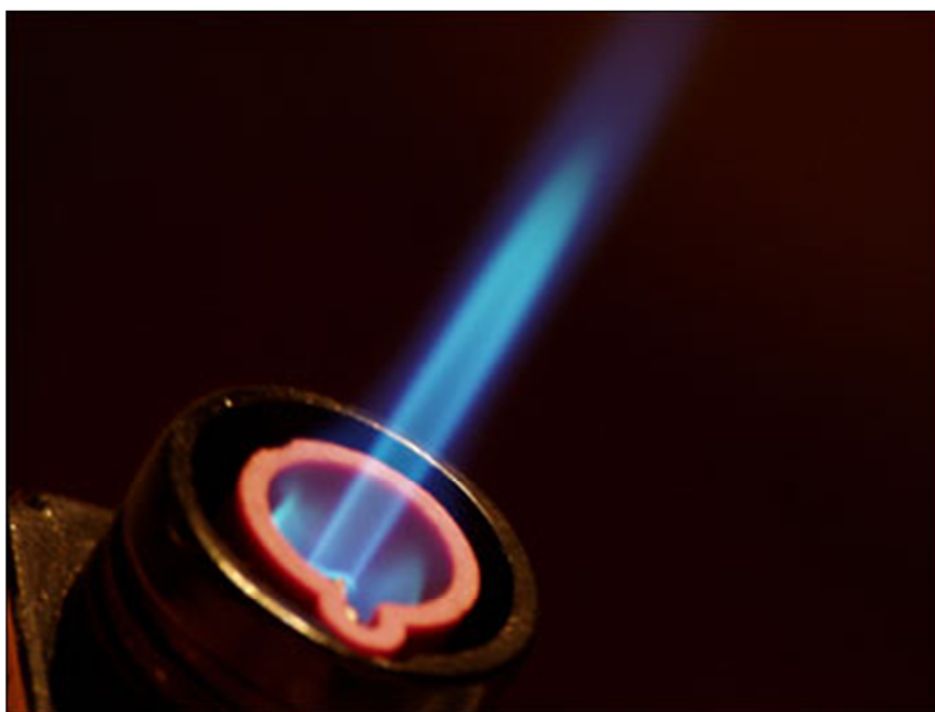
Obr. 26: Tryska propan-butanového hořáku pro aktivaci vzorků
