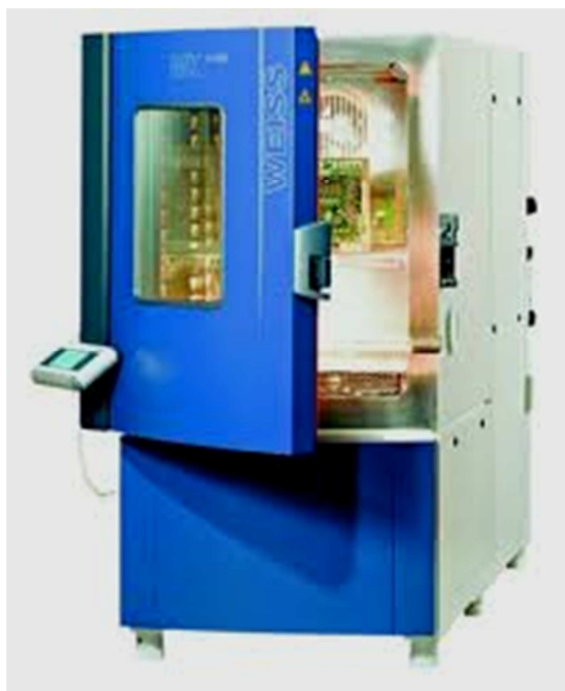
Obr. 10: Klimakomora pro simulaci vlivů prostředí
