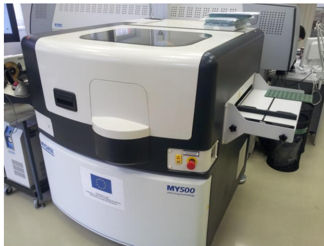
Obrázek 18 – Stroj na tisk pájecí pasty (Vl. zpracování)
