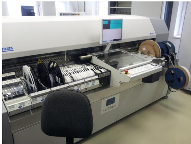
Obrázek 19 – Stroj určený k osazování (VI. Zpracování)
