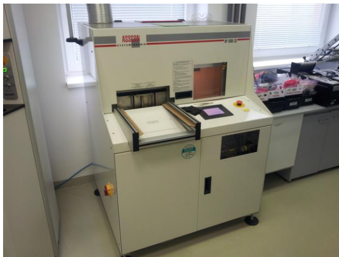
Obrázek 20 – stroj určený pro pájení v parách (VL. zpracování)
