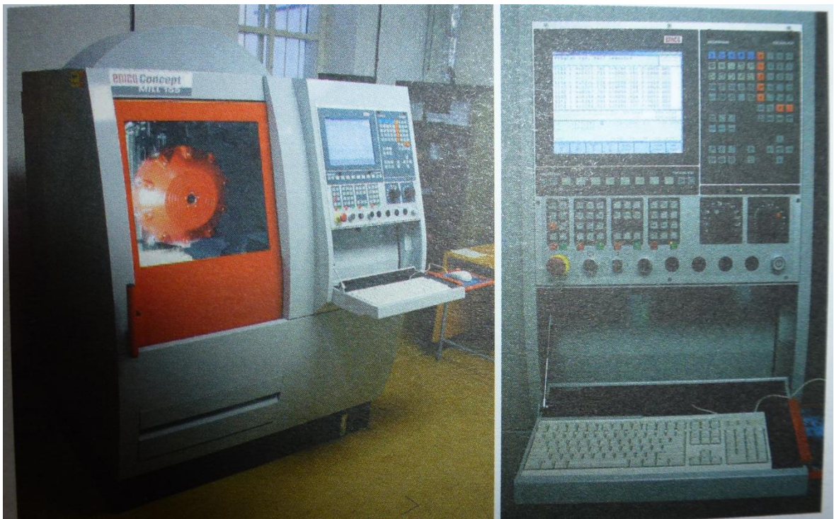
Obr. 14. 3D frézky EMCO MILL 155 a ovládací panel stroje [6]
