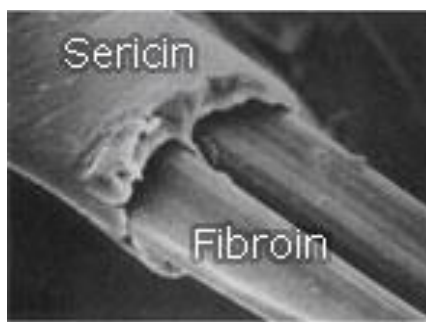
Obr. 7. Struktura sericinu a fibroinu v hedvábném vlákne [62].
