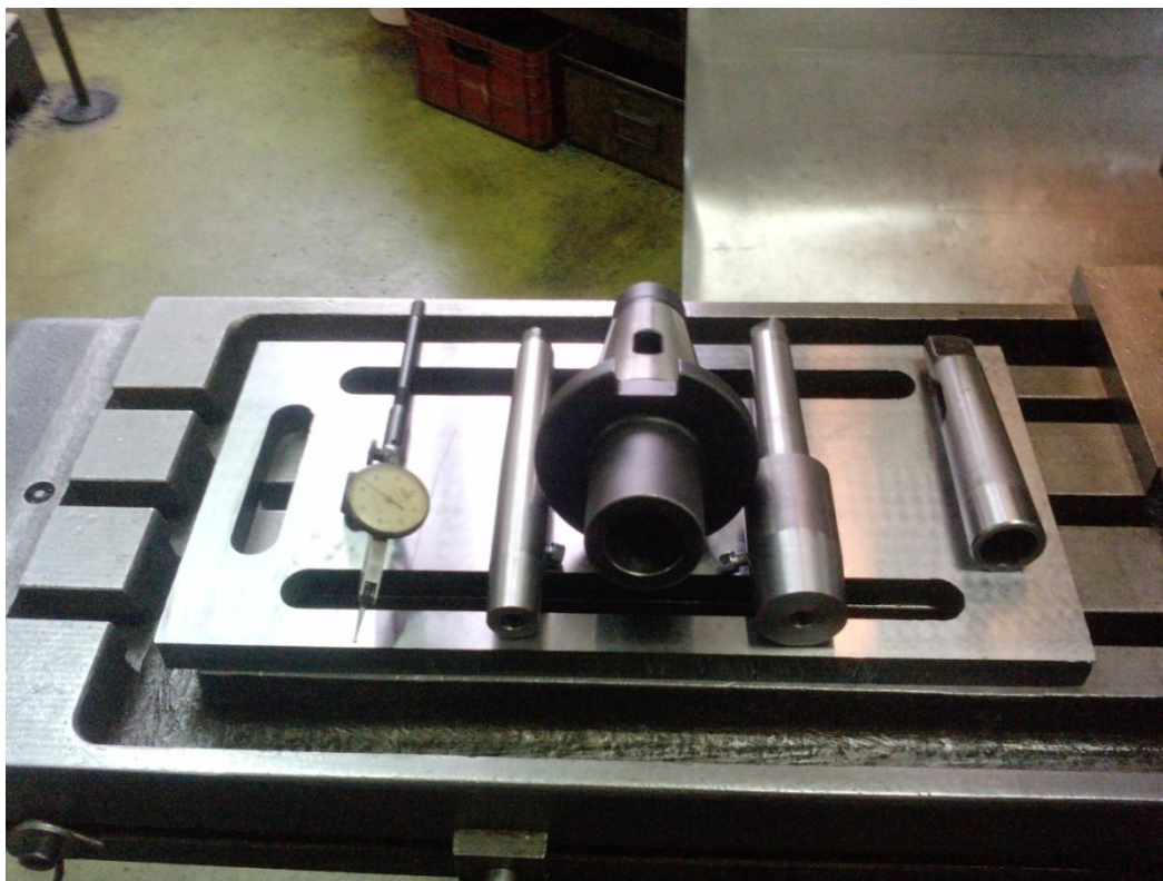
Obr. 29 Sada k měření kruhovitosti
