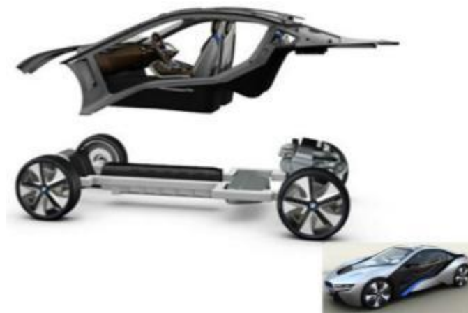
Obr. 18. Karoserie BMW i8 z kompozitního materiálu
