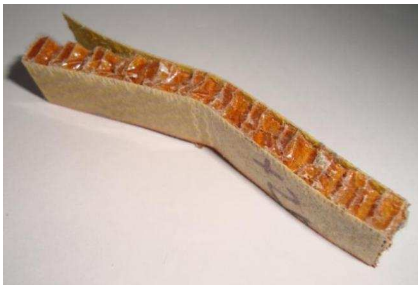
Obr. 56: Přeražený vzorek stlačené struktury s nomexovým jádrem
