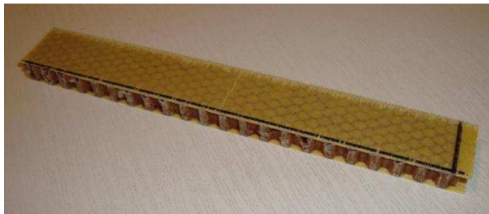
Obr. 45: Zkušební vzorek z nomexového jádra po zkoušce ohybem
