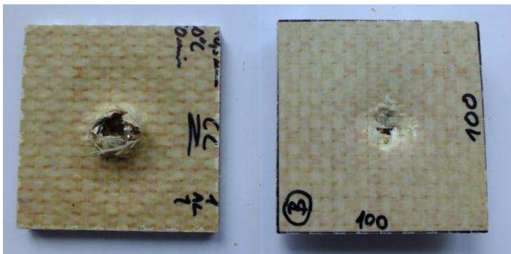
Obr. 65: Vzorek struktury s hliníkovou voštinou po testu
