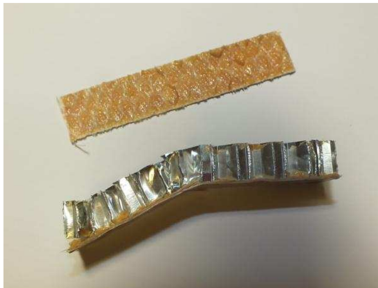
Obr. 57: Přeražený vzorek hliníkové stlačené struktury
