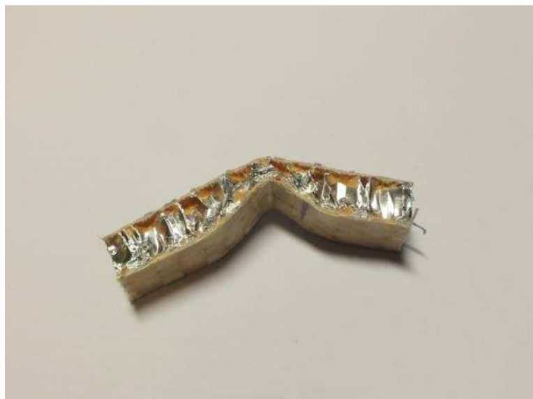
Obr. 58: Přeražený vzorek hliníkové stlačené struktury
