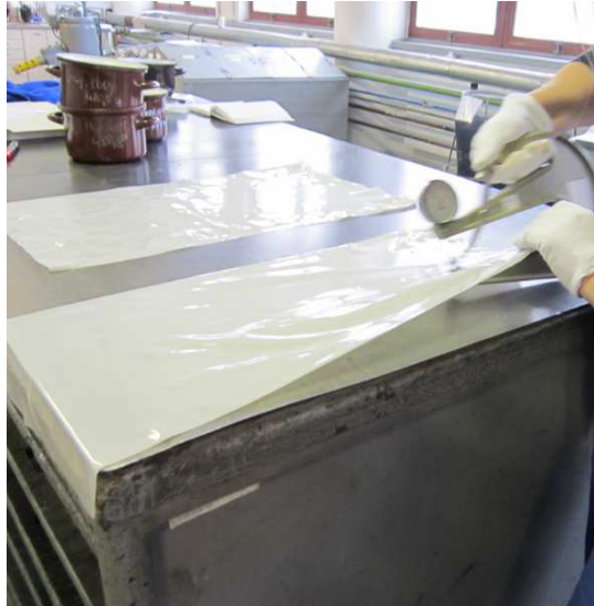
Obr. 40. Měření tloušťky vytažené fólie
