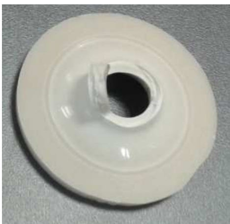
Obr. 55. Zkušební těleso s porušením.
