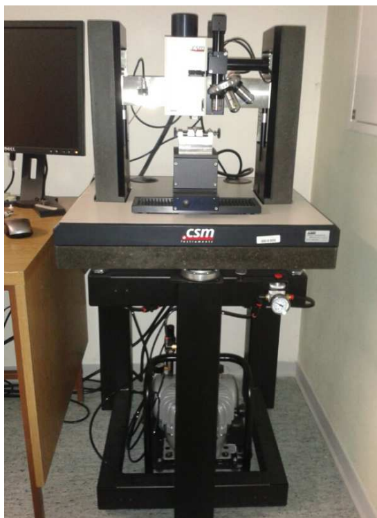
Obr. 49. Zkušební zařízení MicroCombi Tester pro měření mikrotvrdomosti.
