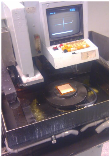
Obrázok 11. Dicer – rezačka a narezaný kus na menovitý rozmer
