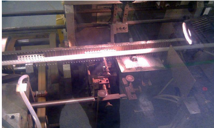
Obrázok 16. Osadené NTC senzory sú čistené v kúpeli s fluxom
