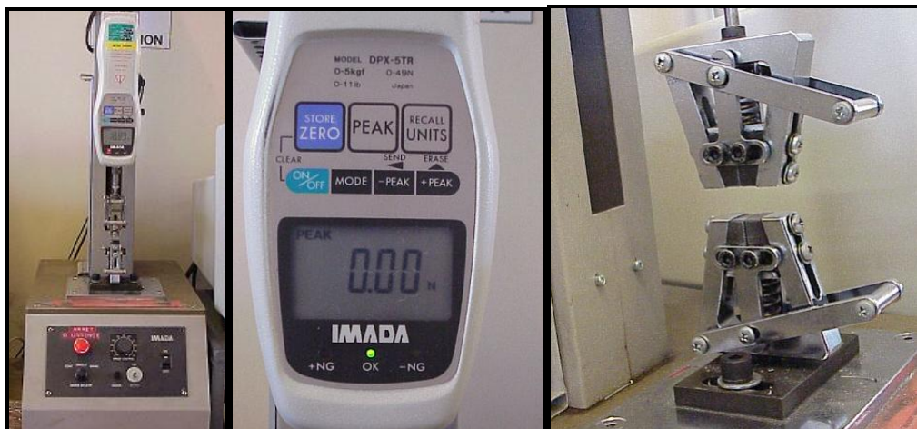
Obrázok 9. zľava doprava: Motorizovaná stolica IMADA MV100AC, dynamometer IMADA DPX-5TR a spínacie čeluste
