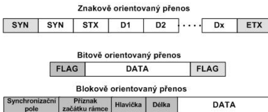
Obrázek 7-3. Typy synchronních přenosů [6]
