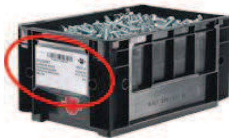
Obr. 25 Umístění etikety na boxu s materiálem [7]
