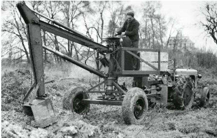
Obrázok 6 – Prototyp bagra s hydraulikou z roku 1950 [interný zdroj PH]
