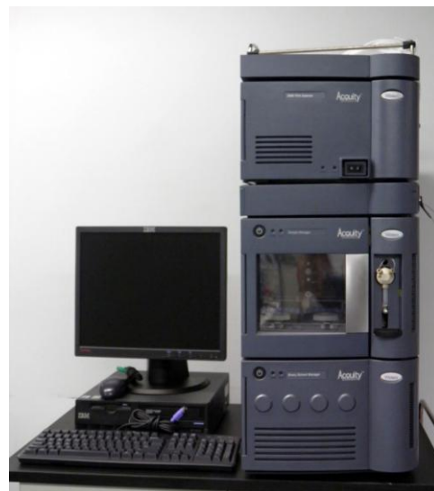
Obr. 17 Kapalinový chromatograf (a – Agilent [36], b – Waters [37])
