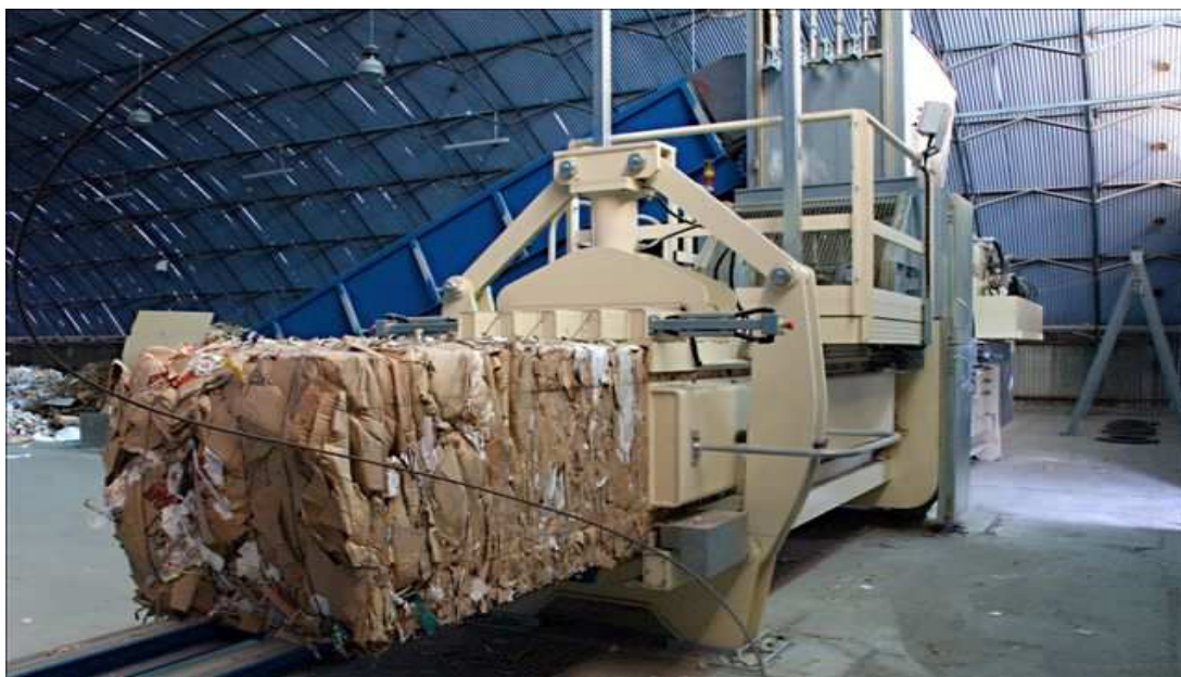
Obr. 18: Slisovaný balík papíru o hmotnosti 500 kg (interní materiály firmy)
