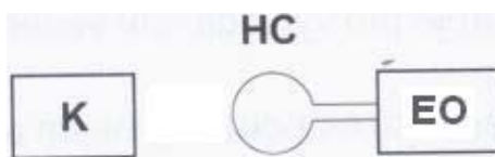
Obrázek 20: Obecné blokové schéma elektronických hledačů kov. předmětů [24]
