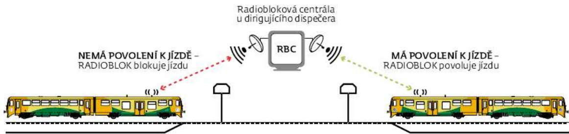
Obr. 8 Komunikace pomocí Radiobloku [15]
