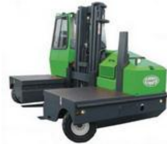
Obrázek 19: Vysokozdvihový vozík s bočním ložením [22]
