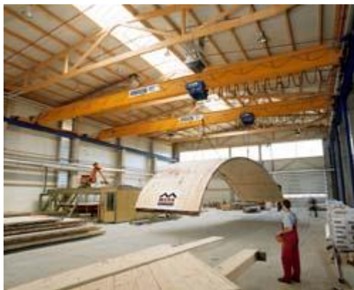
Obrázek 10: Mostový jeřáb jednonosíkový [16]
