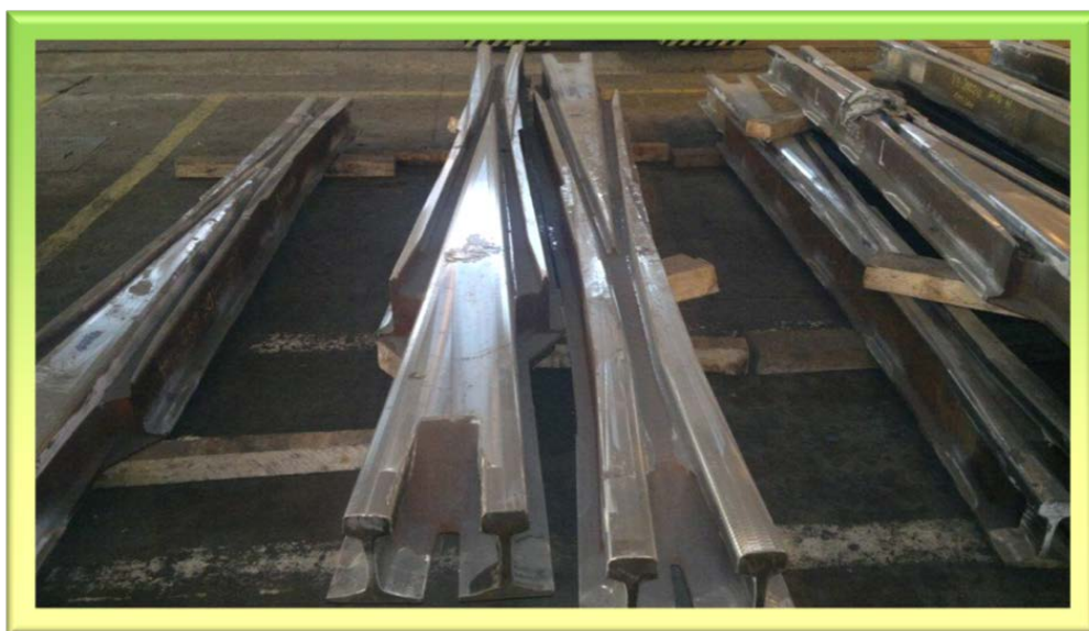
Obrázek 3 - Odlitek manganové srdcovky
