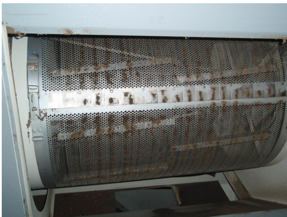
Obr. 7: Separace máku od makoviny [3]
