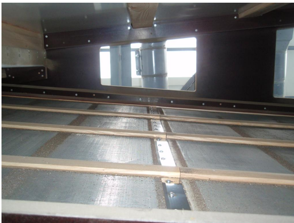
Obr. 9: Síta na čištění předčištěného máku za pomoci vzduchu [3]
