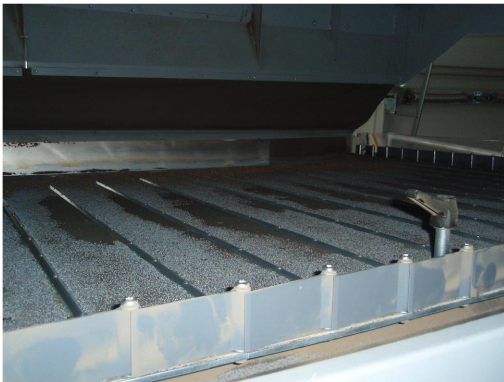
Obr. 10: Pneumatický čistící stůl – čištění materiálů se stejnou velikostí [3]
