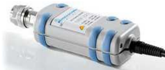
Obr. 20 Detektor výkonu Rohde – Schwarz NRP-Z21
