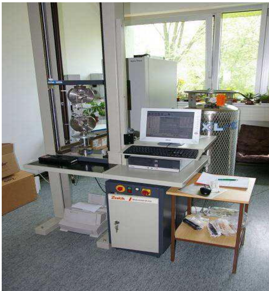
Obr. 16 Univerzální trhací stroj Zwick 1456
