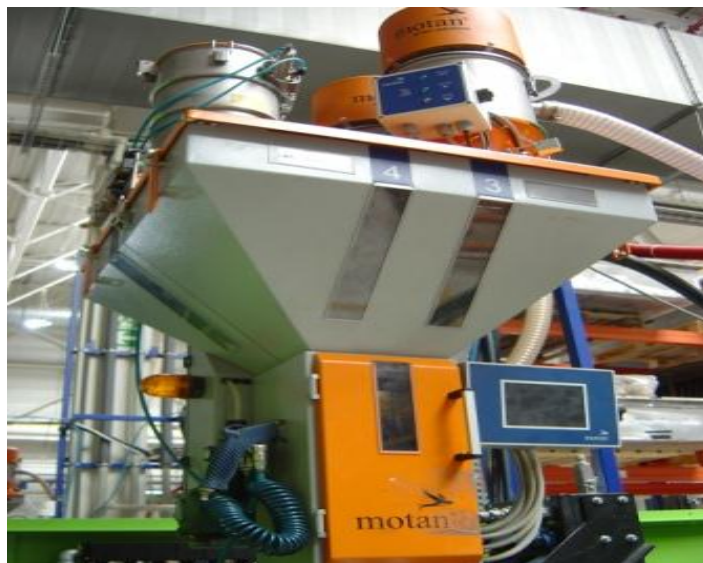
Obrázek 10 Gravimetrická jednotka - Motan GC 60 M-O-Z
