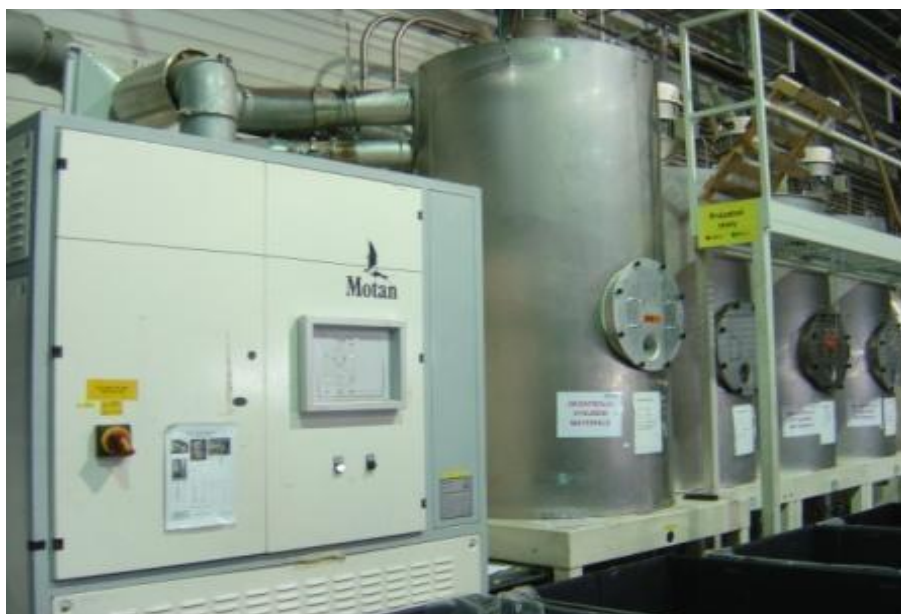
Obrázek 12 Sušicí a dopravní zařízení - Motan MDX 1200
