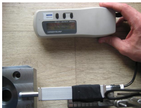
Obr. 266 Měření drsnosti povrchu po obrábění na konvenční horizontální frézce
