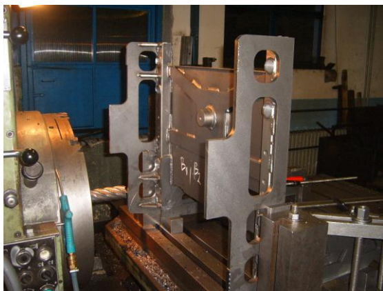
Obr. 32. Obrábění zvedacího rámu na konvenční horizontální frézce W100
