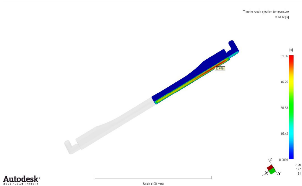
Obr. 70 Čas potřebný k dosažení vyhazovací teploty (vertikální plastikační jednotka)
