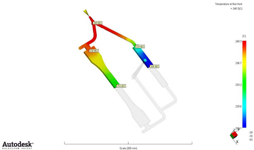
Obr. 68 Teplota na čele taveniny (vertikální plastikační jednotka)
