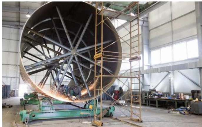
Obr. 4 Lub rotační pece o průměru 5m [16]
