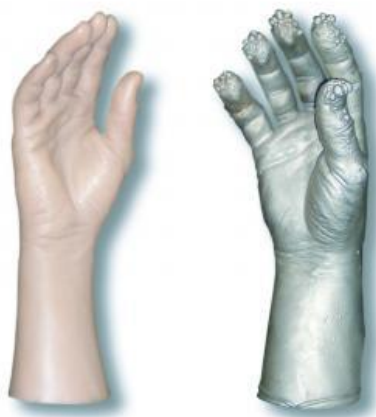
Obrázek 9 Galvanoplastická forma protetické náhrady ruky [16]
