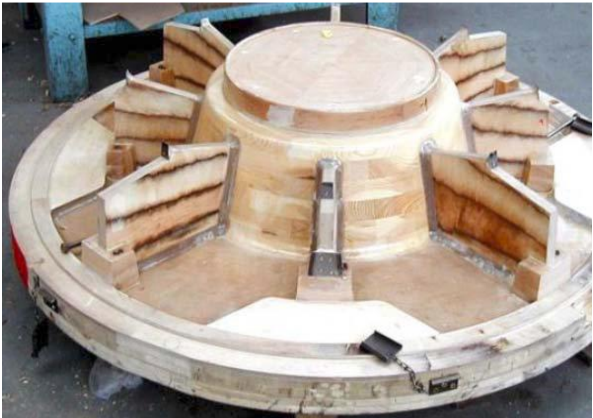
Obrázek 1 Dřevěný slévárenský model vyrobený CNC metodou s následně dodělanými žebry. [1]
