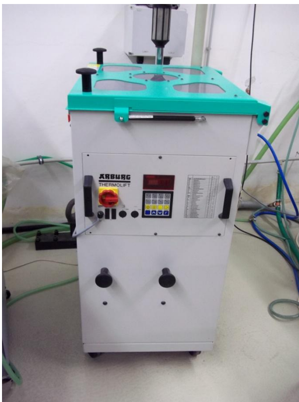
Obr.14 Vysoušecí zařízení Arburg
