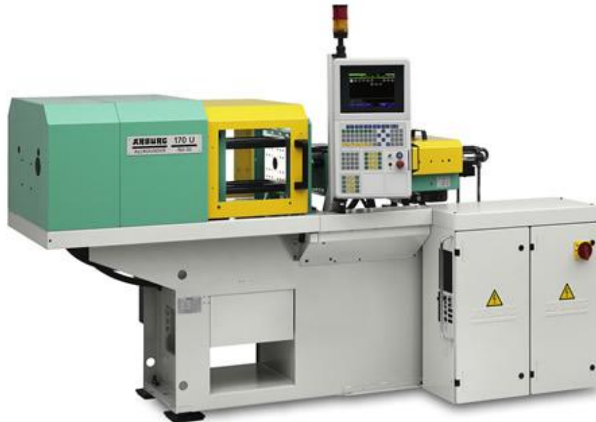
Obr. 15 Vstřikovací stroj Arburg [12]
