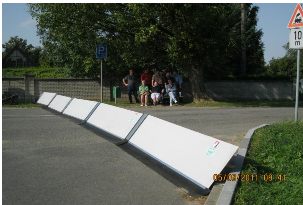
Obrázek 5: Mobilní protipovodňová zábrana 15 metrů [autorův archiv].
