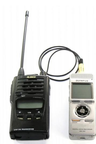
Obrázek 10 UHF přijímač Alinco S s připojeným diktafonem 21
