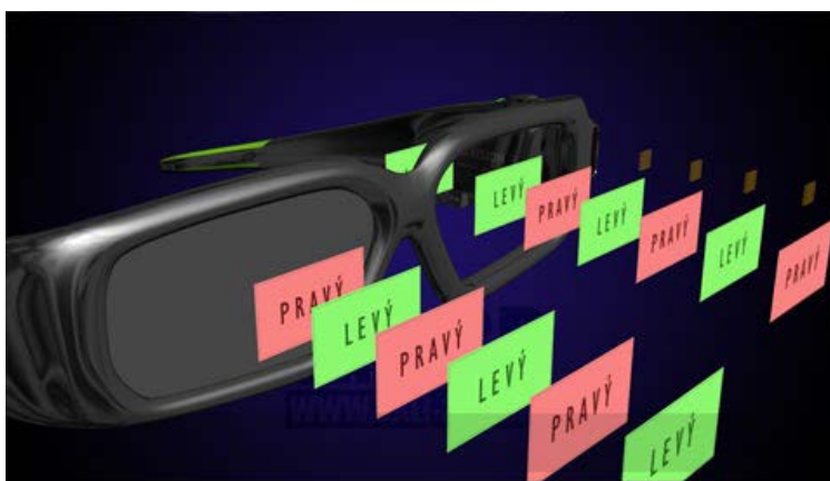
Obr. 88. Aktivní systém projekce, funkce závěrkových brýlí.
