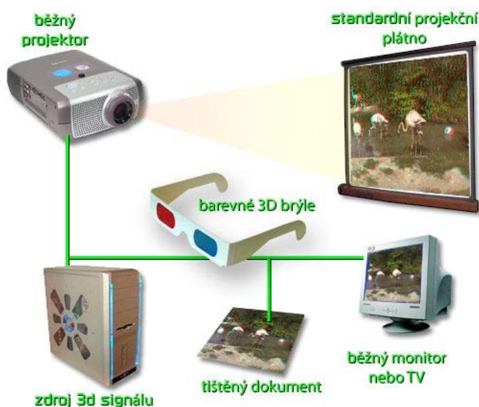
Obr. 87. Schéma anaglyfického systému 3D projekce.
