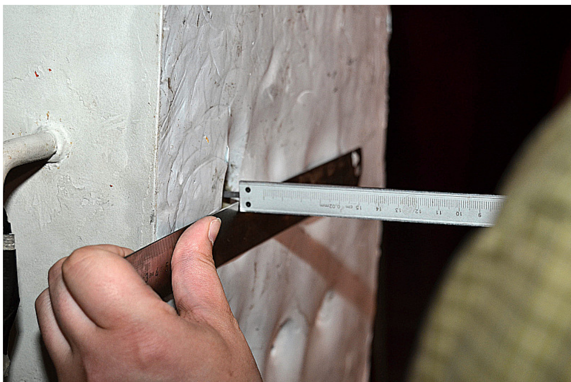
Obr. 17. Měření hloubky průtisku způsobeného zásahem
