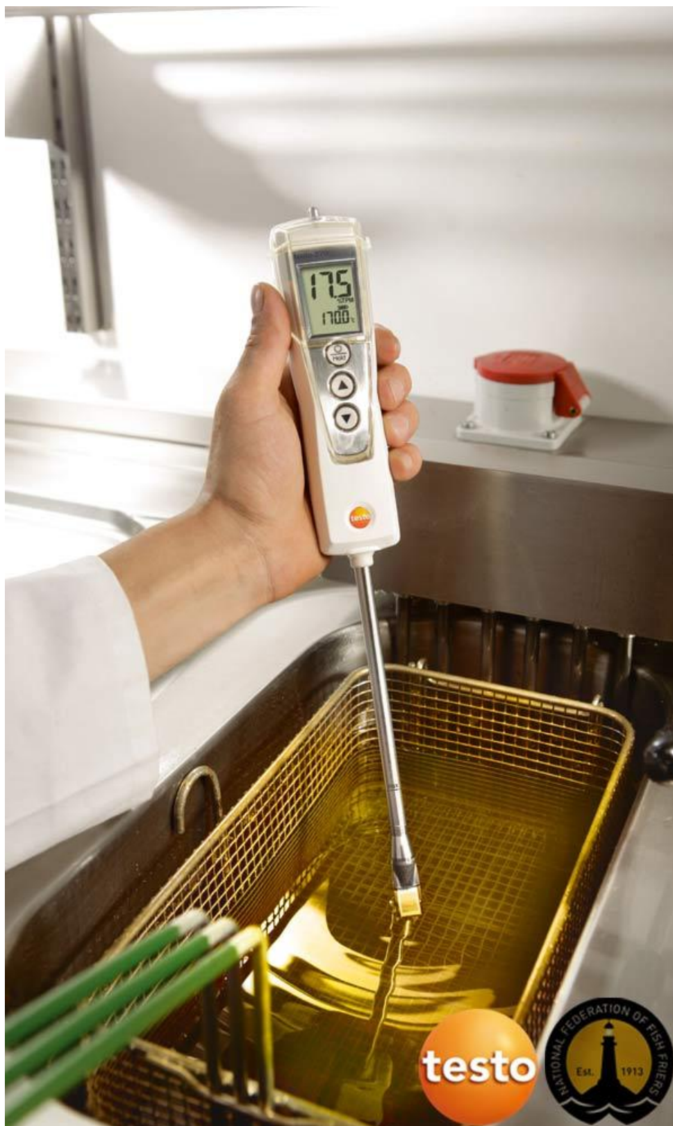
Obr. 4 Přístroj měření TESTO 270 [67]
