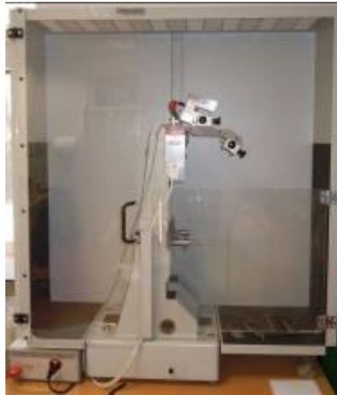
Obrázek 44- Přístroj ZWICK/Roell B5 113
