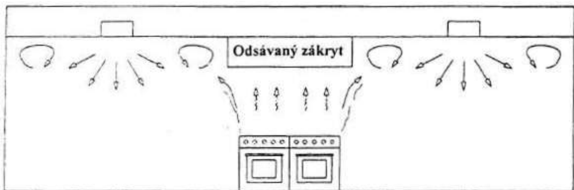
Obrázek 9.2 - Vertikální přívod vzduchu směřováním vířivými vyústkami [36]
