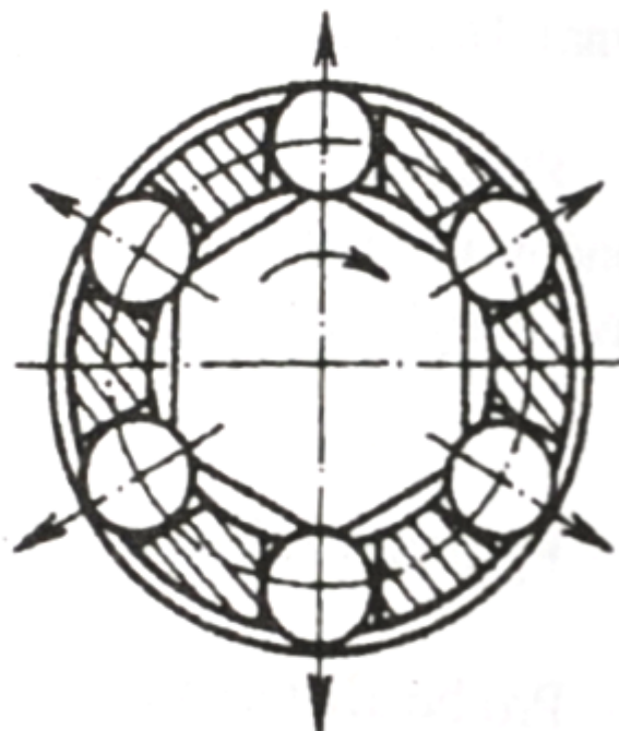
Obr. 10 Princip dynamického válečkování[2]
