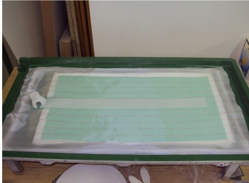
Obr. 47. Položení Greenflow, Resinrak a RIC konektoru
